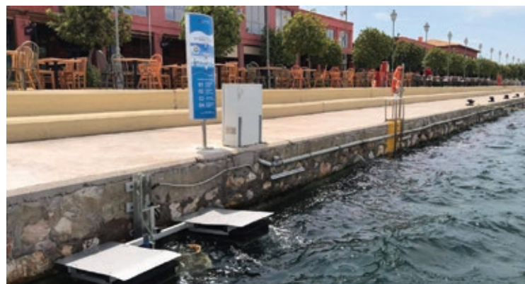
Το Seabin αποτελεί μία καινοτόμο λύση για την απομάκρυνση των πλαστικών από το θαλάσσιο περιβάλλον
